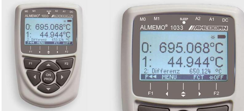
**Referenzmessgerät für Temperatur.
